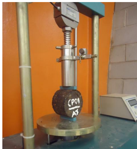
Figura 3: Ensaio de resistência à tração por compressão diametral
